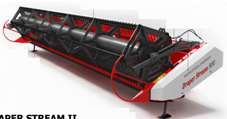
DRAPER STREAM II транспортная, с функцией укладки в валок, с гибким ножом 9,4-12,4 м
