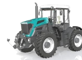
ООО «Брянский тракторный завод» (Брянская область) трактор интегральной компоновки III тягового класса с двумя управляемыми мостами
