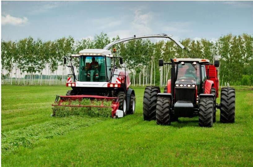
**RSM IQ-Dozer** - порционирование консерванта в зависимости от влажности массы позволяет в автоматическом режиме вносить необходимую дозу консерванта, в зависимости от производительности комбайна и состояния кормовой массы
