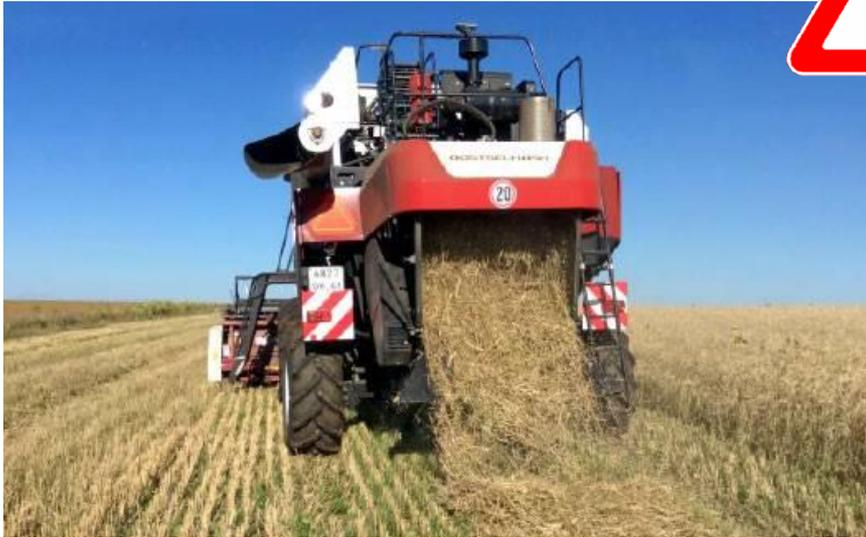
Для корректировки направления разбрасывания в задней части комбайна устанавливаются два датчика бокового ветра и привод изменения угла разбрасывания вкупе с алгоритмом изменения оборотов разбрасывателей
